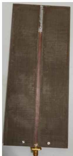
Figura 26: Alimentador de linha de microfita sobre substrato aterrado (2).
