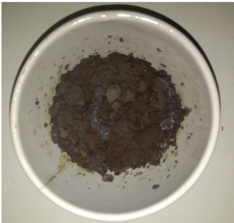
Figura 31 – Produto obtido após a calcinação da ferrita de cobalto ( \text{CoFe}_2\text{O}_4 ).
