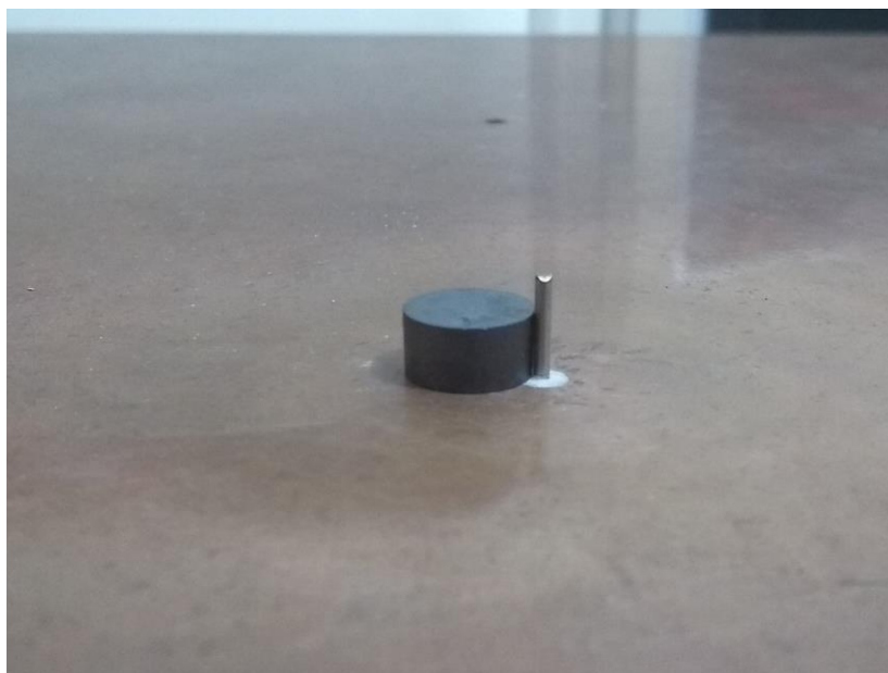
Figura 55 - Estrutura de medição da antena DRA.
