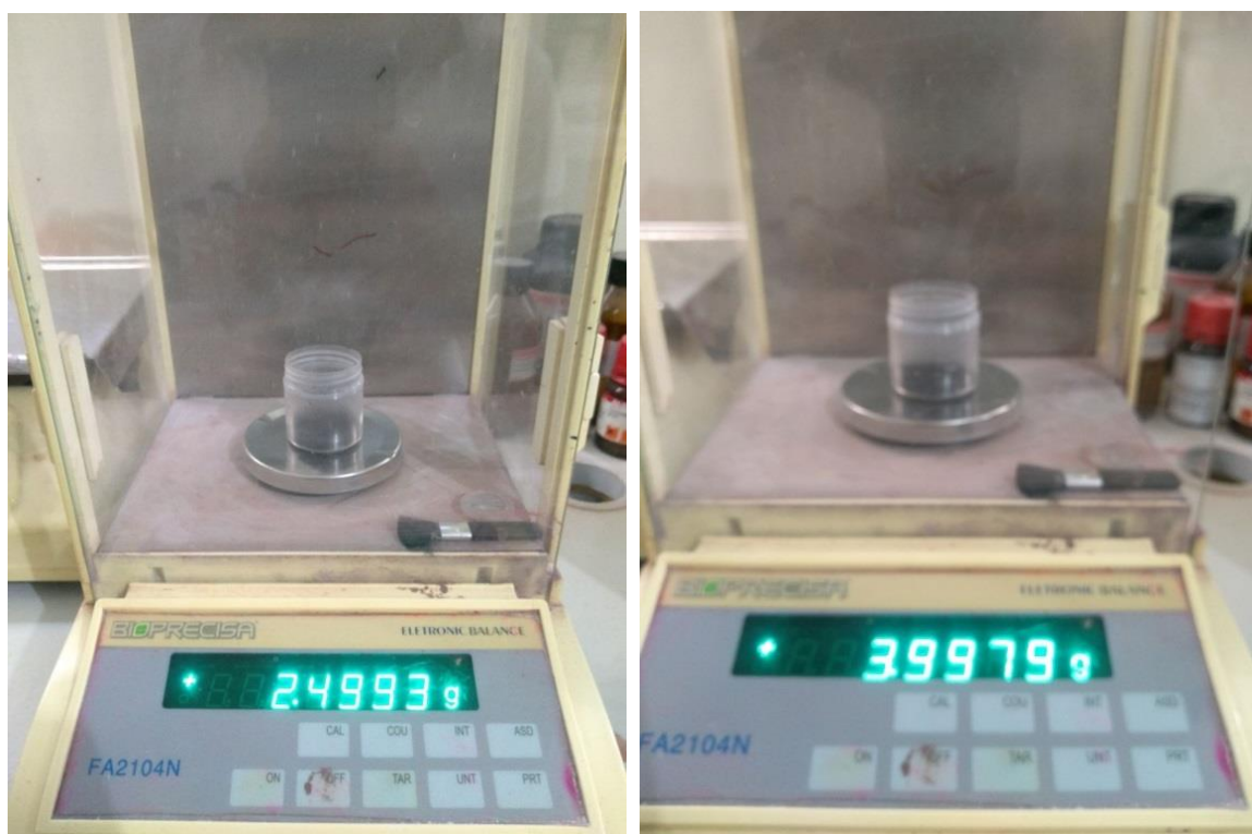
Figura 37 - Medição das massas de Ferrita de Cobalto para prensagem das pastilhas cilíndricas (a) e toroidais (b).
