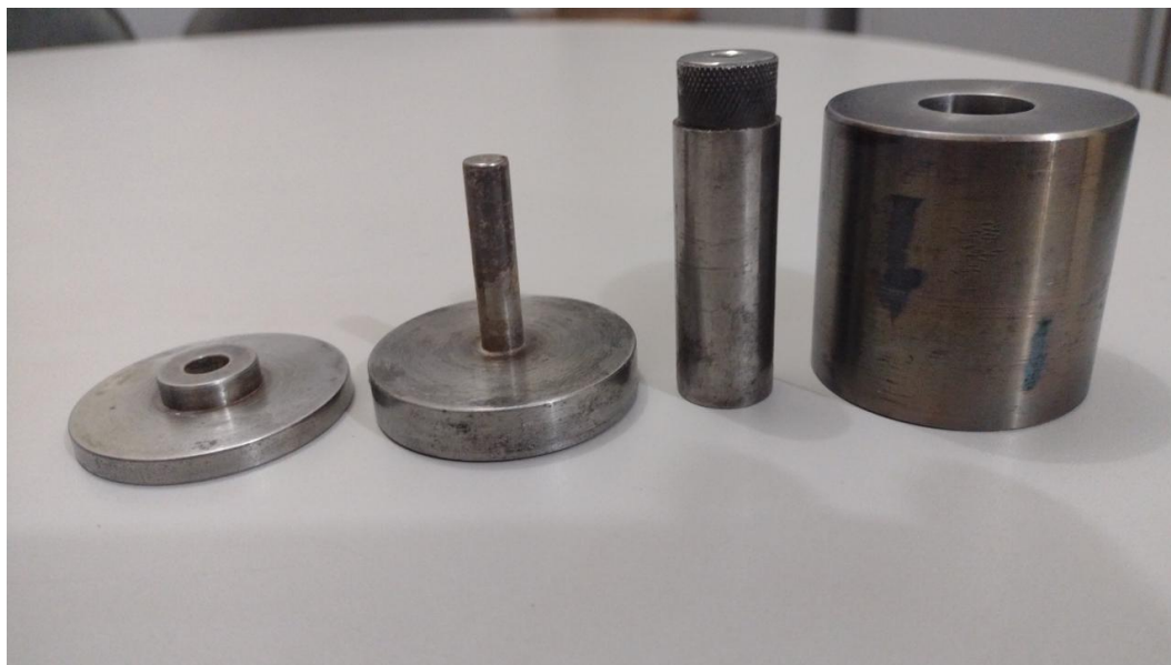
Figura 36 – Matrizes utilizadas para prensagem das pastilhas toroidais.
