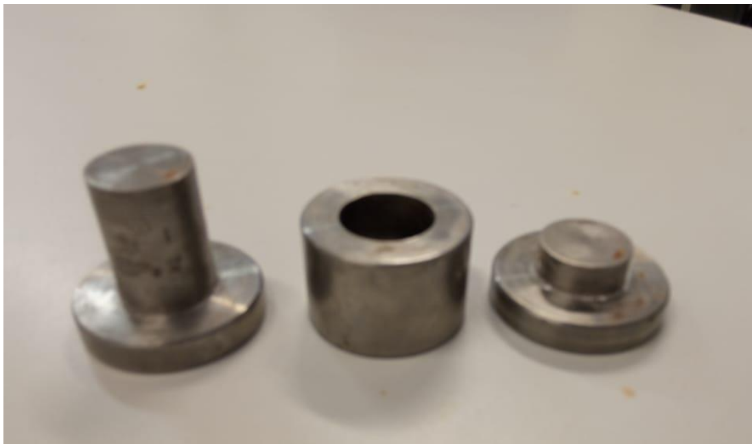
Figura 35 – Matrizes utilizadas para prensagem das pastilhas cilíndricas.
