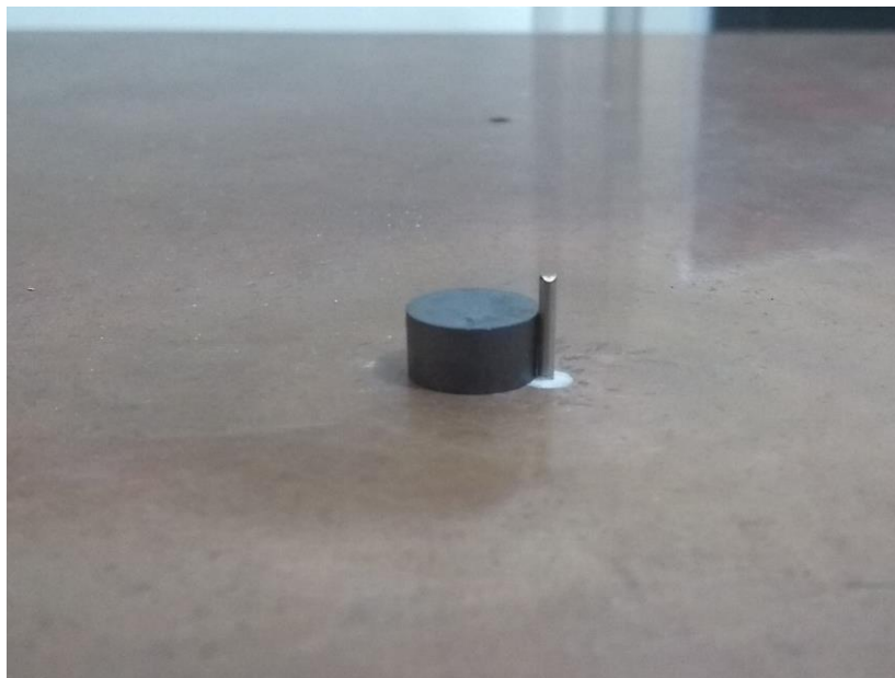
Figura 55 - Estrutura de medição da antena DRA.
