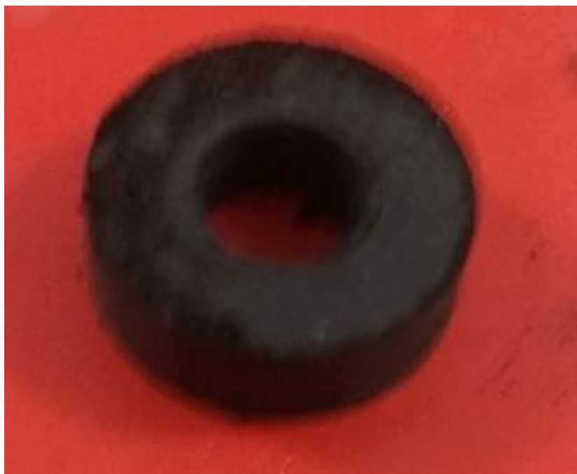
Figura 34 – Material compactado em formato toroidal.
