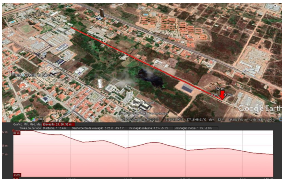
Figura 88: Teste de distância com a antena dipolo.
