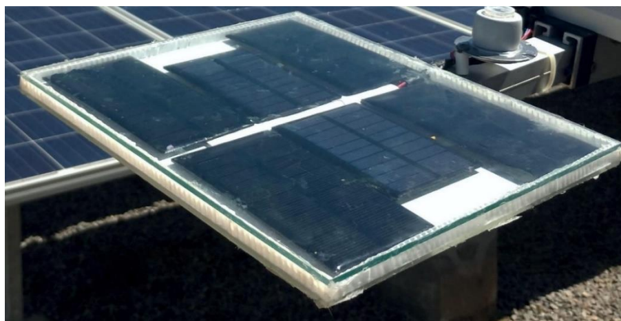
Figura 105: Placa solar para alimentação do sistema.
