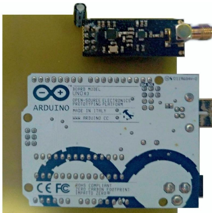
Figura 97: PCI de recepção com os componentes instalados.
