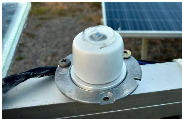
Figura 104: Estrutura de fixação do piranômetro de fotodiodo.
