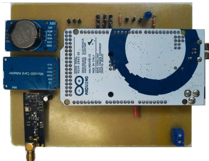
Figura 94: PCI de transmissão com os componentes instalados.
