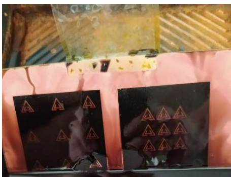
Figura 45 - Antenas imersas em solução ácida de percloroeto de ferro
