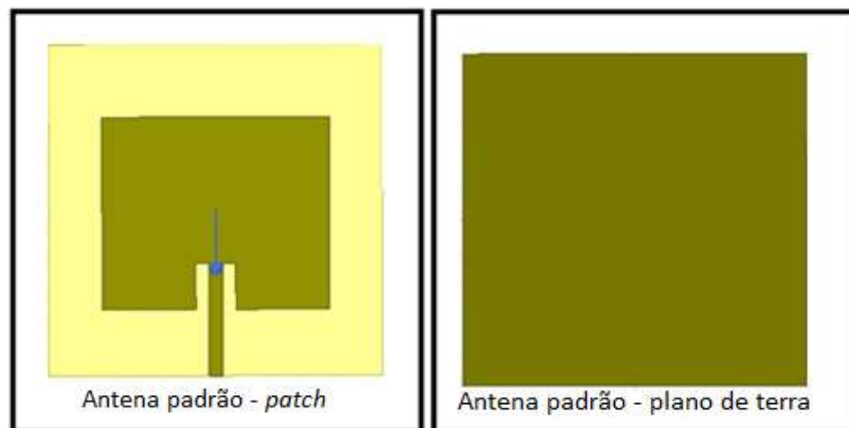
Figura 40 – Antena padrão do tipo patch com técnica de casamento de impedância inset feed
