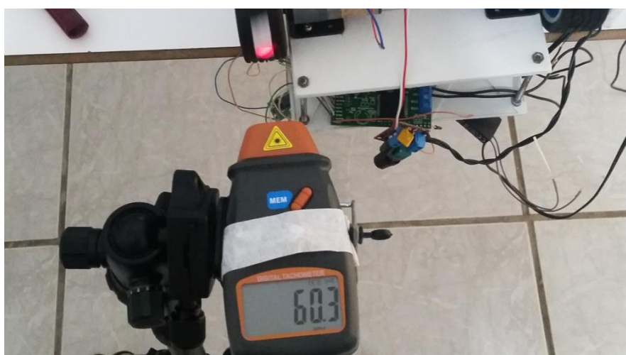
Figura 33 - Tacômetro medindo o RPM do Motor B
