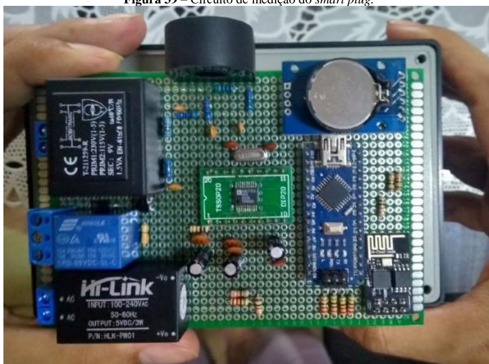
Figura 39 – Circuito de medição do smart plug .
