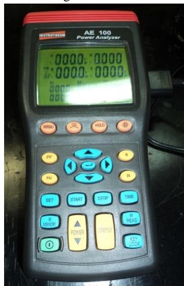
Figura 42 – Analisador de energia AE-100 utilizado nos testes de precisão.
