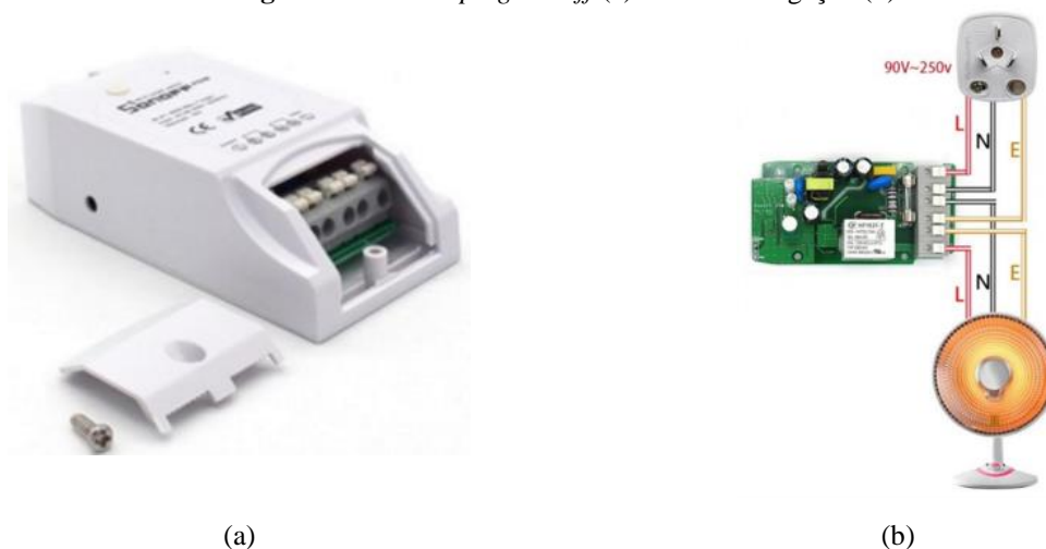
Figura 16 – Smart plug Sonoff (a) e forma de ligação (b).
