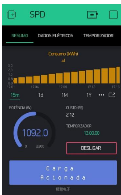
Figura 36 – Aba “RESUMO” do aplicativo para monitoramento e controle do smart plug .
