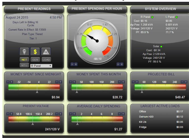
Figura 13 – TED 5000 Energy Detective (a) tela do sistema supervisorio do aparelho (b).
