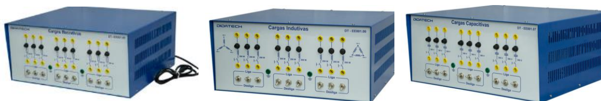
Figura 41 – Bancada de cargas resistivas, indutivas e capacitivas para o teste de precisão.
