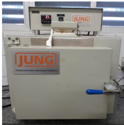
Figura 40 - Forno tipo mufla utilizado para resfriamento da cera de carnaúba diluída
