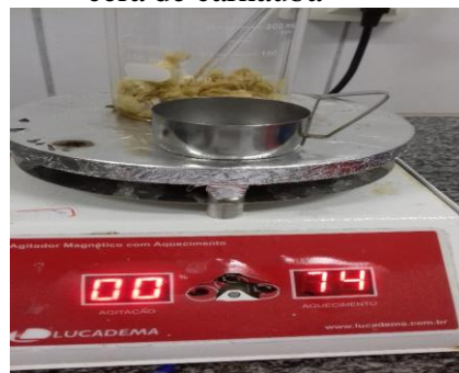
Figura 46 - Agitador Magnético com Aquecimento utilizado para a obtenção da pastilha de cera de carnaúba
