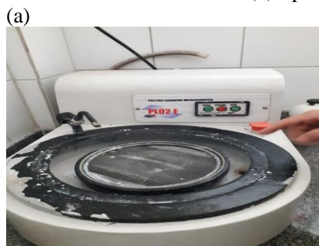
Figura 41 - (a) Politriz Lixadeira Metalográfica utilizada para polir a cera de carnaúba sílica e (b) tipos de lixas utilizadas na máquina
