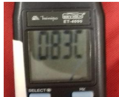
Figura 47 - (a) Termostato utilizado na obtenção da temperatura de fusão da cera de carnaúba (b) Temperatura de fusão obtida no experimento
