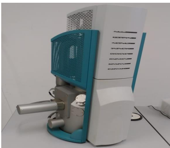
Figura 29 - (a) Fotografia do Microscópio Eletrônico de Varredura pertencente à UFERSA (b) Metalizador para deposição de material condutor na superfície do corpo de prova
