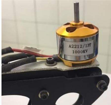
Figura 28: Motor de corrente contínua sem escovas
