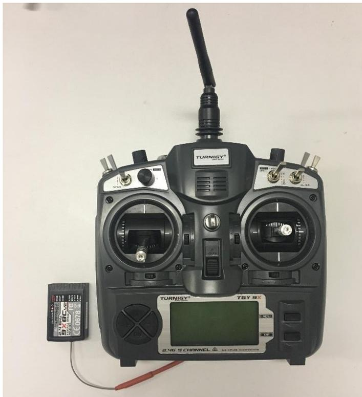
Figura 32: Rádio controle Turnigy 9x 9CH e receptor Turnigy 9X8C-V2
