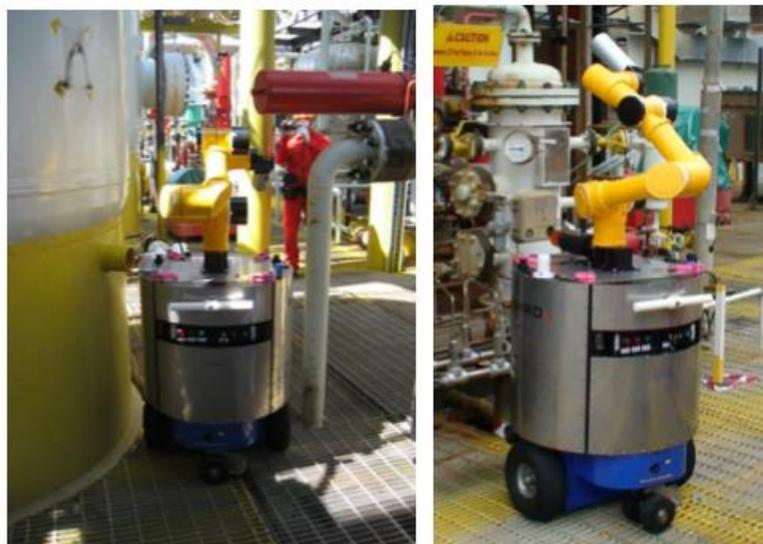
Figura 1: Robô móvel para inspeção e manutenção em instalação de petróleo e gás
