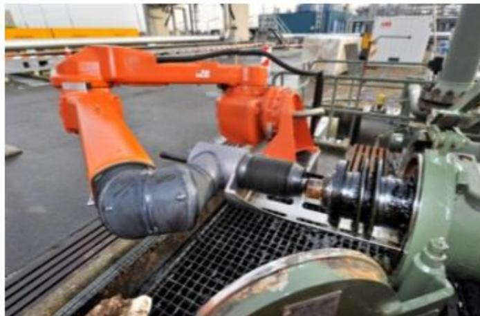
Figura 4: Robô para manipulação de raspador
