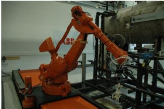
Figura 3: Robô de manipulação de válvula
