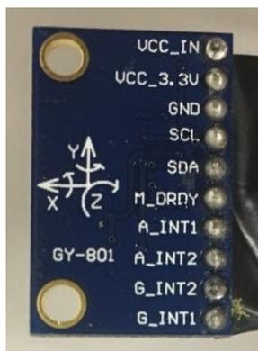
Figura 34: Unidade de Medição Inercial (IMU) GY-80
