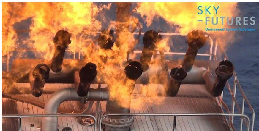
Figura 7: Imagem da chaminé em uma plataforma obtida com o quadricóptero
