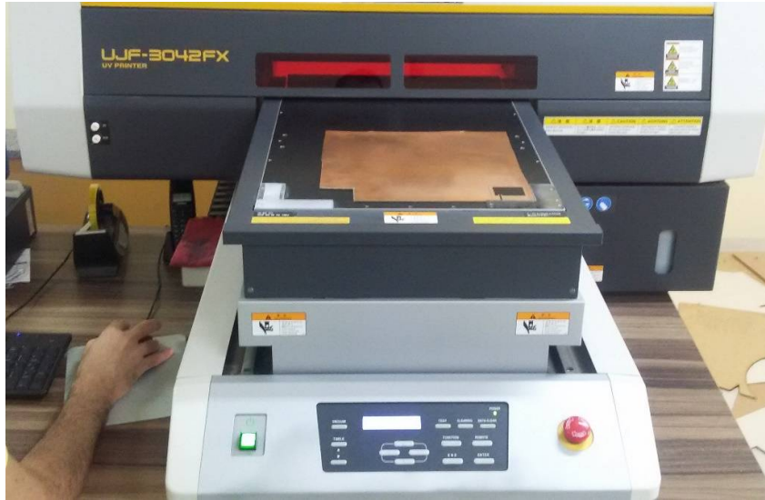
Figura 36 - Processo de plotagem em uma placa de FR4.
