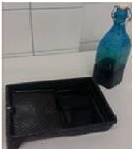
Figura 37 - Solução de perclorato de ferro utilizado para fabricação das antenas;
