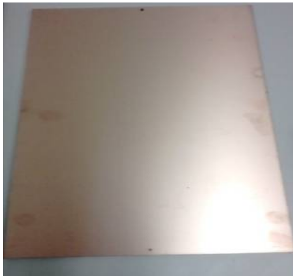
Figura 35 - Placa de FR4 utilizada para confecção das antenas fabricadas.
