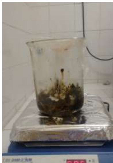
Figura 24: Secagem da solução aquosa no agitador magnético.
