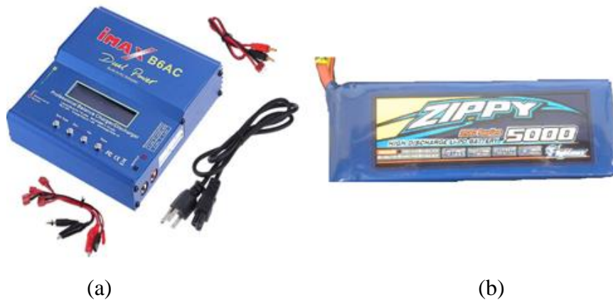
Figura 66- (a) carregador de balanceamento imax B6AC,(b) bateria Li-Po ZIPPY 5000 mAh.
