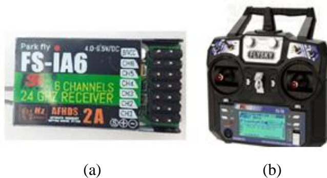
Figura 63- Sistema de rádio FlySky FS-IA6 . (a) receptor, (b) transmissor.
