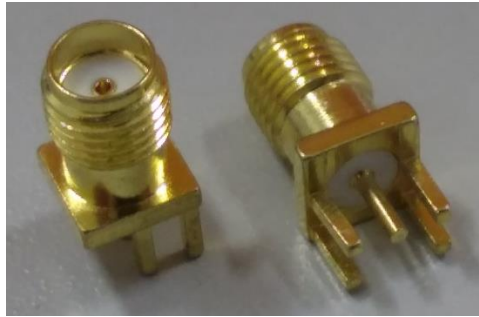
Figura 73- Conector SMA fêmea reto de quatro pinos.
