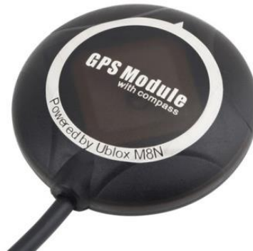
Figura 67- Módulo GPS Ublox M8N .
