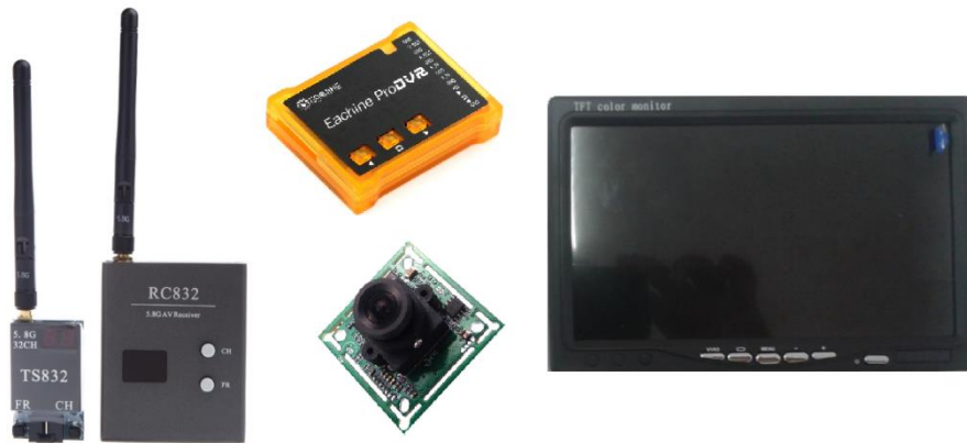
Figura 68- (a) Kit FPV para registro de imagens captadas pelo VANT. (b) Bateria Li-Po RHINO 2350 mAh para alimentação do módulo em terra.
