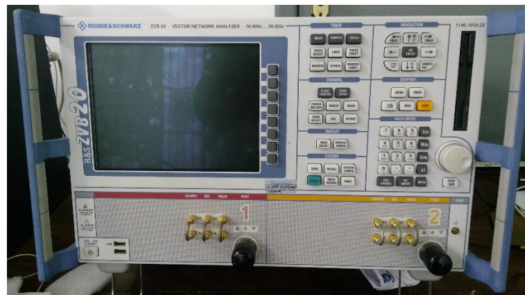
Figura 74- Analisador de Redes Vetoriais.
