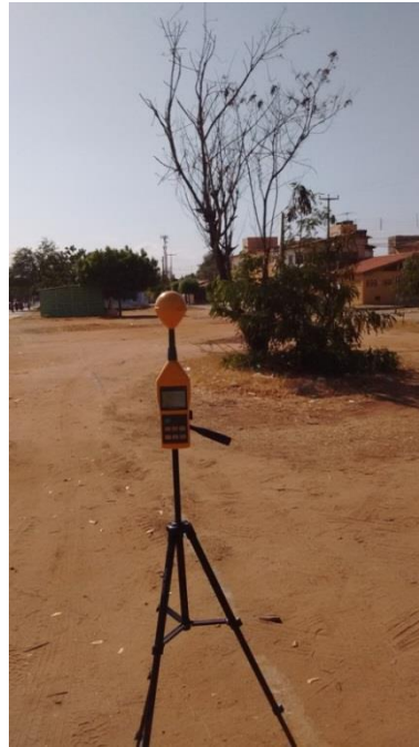
Figura 28 - Medidor Tenmars TM-196 montado sobre o tripé.
