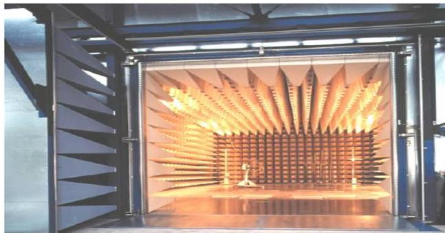
Figura 11: Fotografia de uma câmara anecóica para operação na faixa de frequências de 28MHz a 2GHz.
