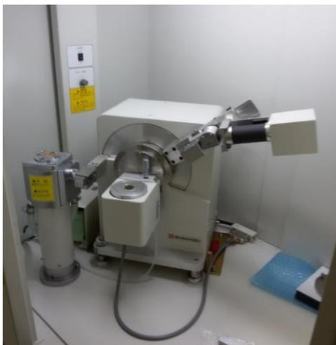
Figura 22: Fotografia de equipamento de difratometria de raios-X.
