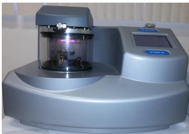
Figura 25: Fotografia de metalizador realizando a deposição de material condutor na superfície de partes dos corpos de prova.
