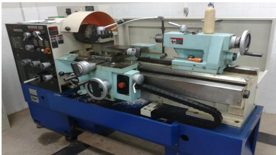
Figura 17: Fotografia de torno mecânico usado para a mistura dos pós.
