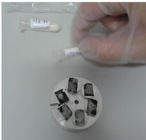
Figura 24: Fotografia de pós colocados em superfícies para análise no MEV.
