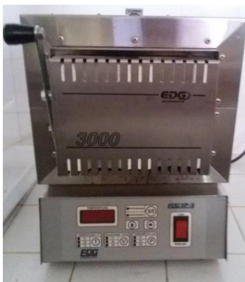
Figura 19: Fotografia de forno tipo mufla.
