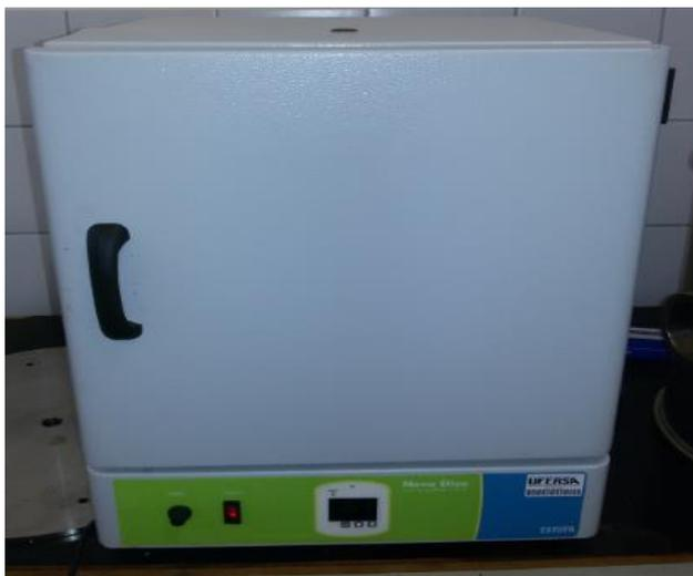
Figura 15: Fotografia de estufa usada na secagem dos pós.
