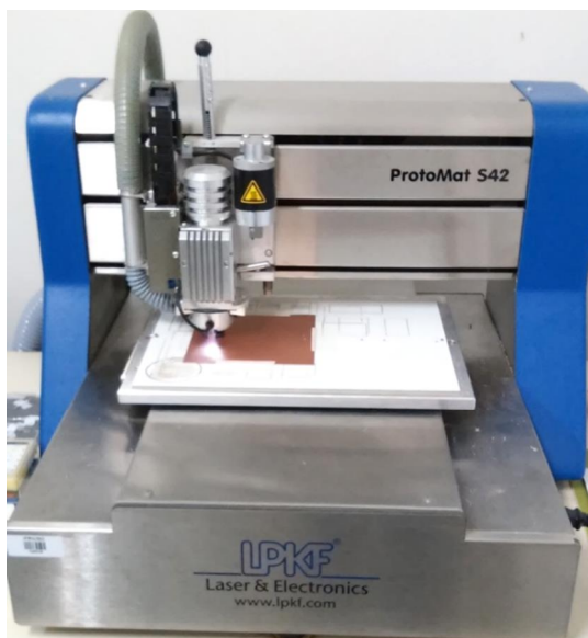
Figura 43: Fresa de prototipagem utilizada na fabricação das antenas. Fonte: Autoria Própria, 2016.
