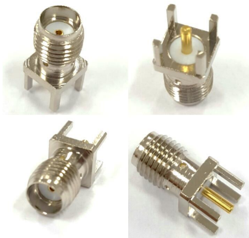
Figura 56: Conector SMA usados nas antenas. Fonte: Autoria Própria, 2016.
