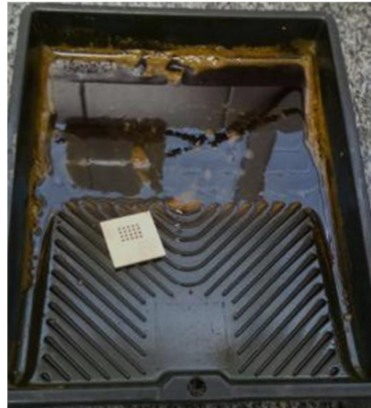
Figura 49: Processo de corrosão das estruturas utilizando Percloroeto de Ferro ( \text{FeCl}_3 ). Fonte: Autoria Própria, 2016.
