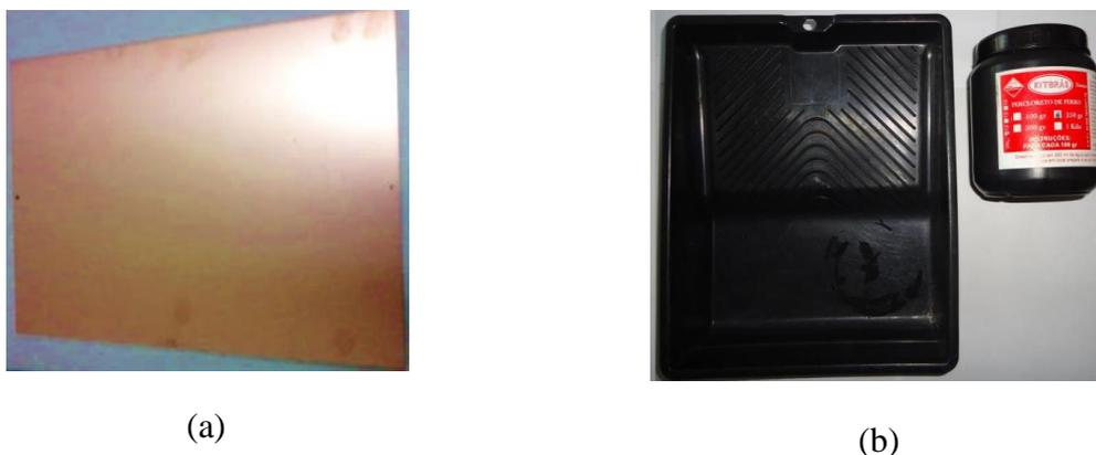
Figura 36 – (a) Placa de FR4 (b) Solução de perclorato de ferro.
