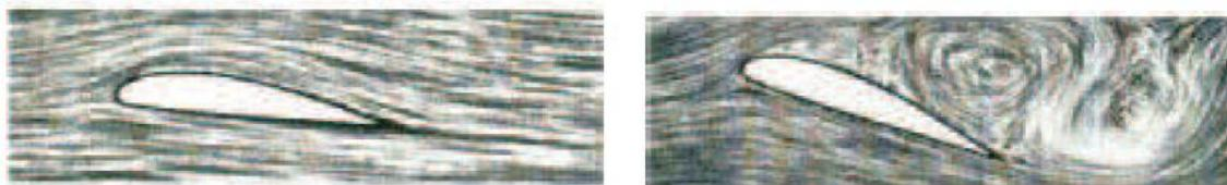
Figura 10 – (a) Fluxo de ar aderente ao perfil da pá (b) Fluxo separado (estol) em volta do perfil
