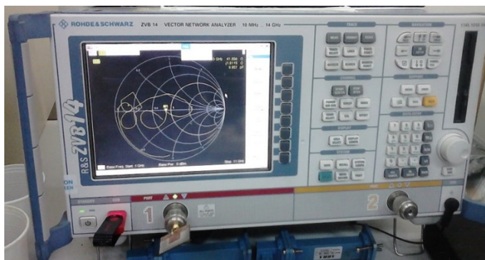
Figura 64 - Analisador de Rede Vetorial utilizado para medição.
