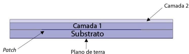
Figura 30 - Representação da antena com múltiplas camadas dielétricas.
