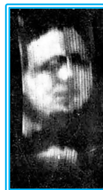
Figura 5 - Imagem obtida pelo disco de Nipkow Fonte: COLORIZE MÉDIA, (2015)
