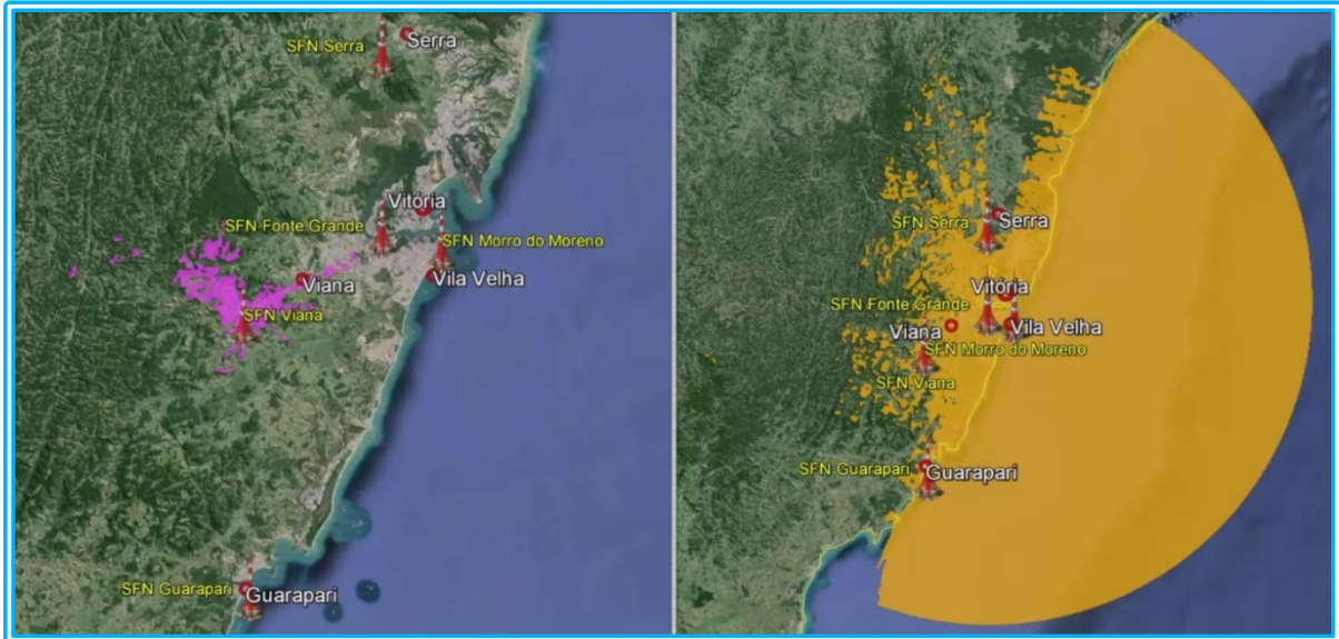
Figura 54 - Cobertura Tx Viana X Cobertura Tx Vitória Fonte: Autoria Própria
