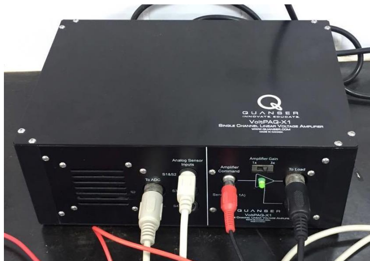
Figura 15: Drive Quanser ® Fonte: Autoria própria
