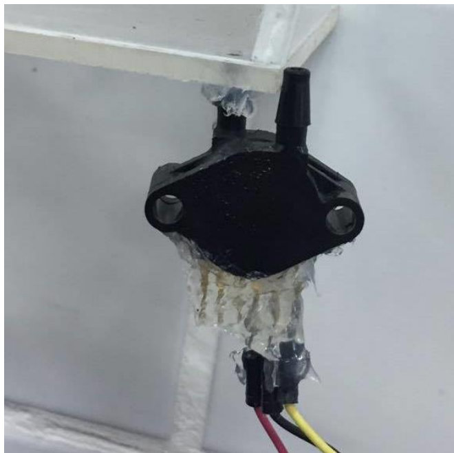
Figura 12: Sensor MPX5010. Fonte: Autoria própria
