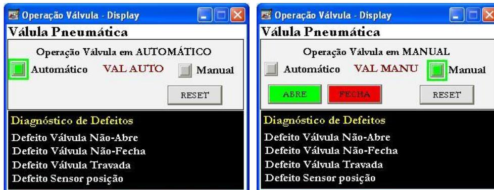
Figura 37 – Tela Operação Válvula. (1) Operação em automático; (2) Operação em manual.
