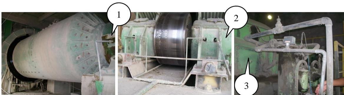
**Figura 14 – (1) Mancal moinho de bolas, (2) Mancal dos rolos de apoio do forno rotativo, e (3) Redutor do acionamento do moinho de bolas.**
