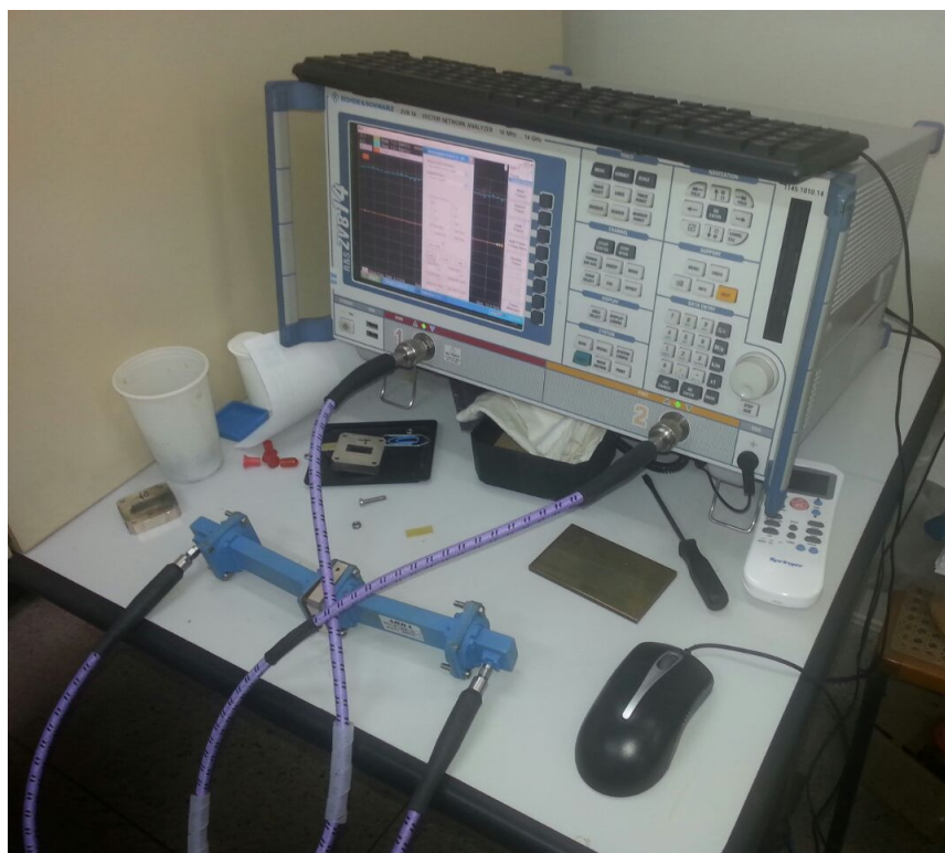
Figura – 24: Analisador de Redes Vetorial da Rohde Schwartz, modelo ZVB14 caracterizando eletricamente o substrato a base de Pentóxido de Nióbio – Nb_2O_5 . Medições da Permissividade Elétrica ( \epsilon_r ) e Tangente de perdas ( \tan \delta ).
