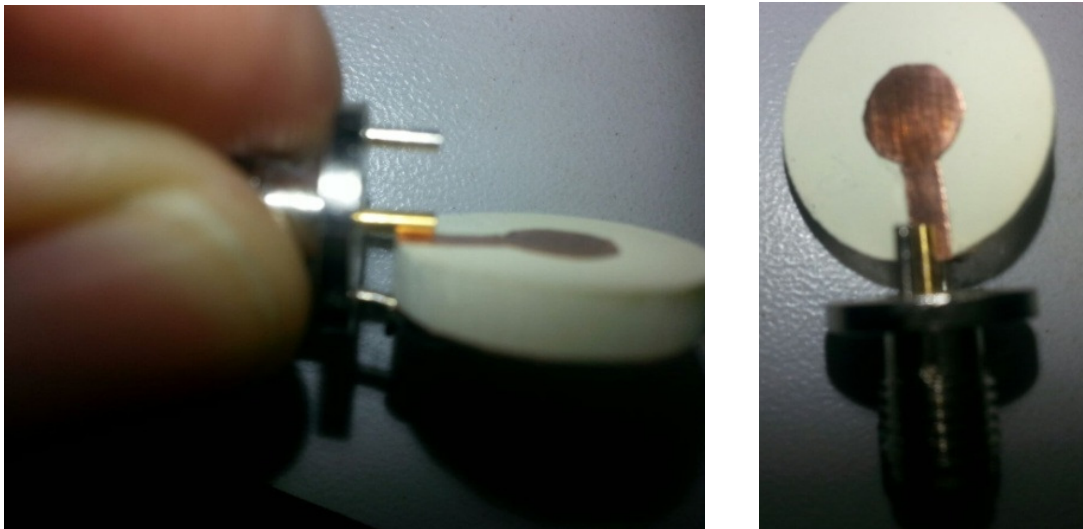
Figura 25 – Antena de Microfita com Patch na forma circular disposta sobre o substrato dielétrico a base de Pentóxido de Nióbio – Nb_2O_5 .
